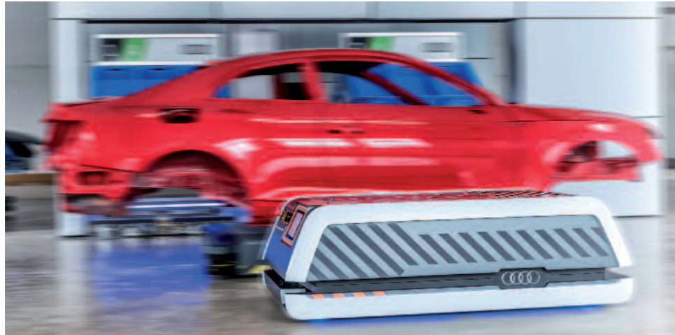
Flexible Verkettung durch den Einsatz von Fahrerlosen Transportfahrzeugen (FTF) anstelle starrer Fließbänder.
