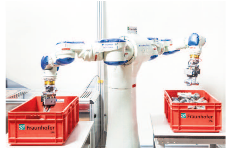
Zweiarmroboter für den Griff-in-die-Kiste mit neuronalen Lernverfahren.
