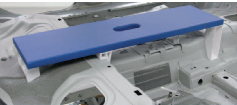
Gewichtsoptimierte Montagebank (60 % Gewichtsreduktion): Strukturoptimierte, additiv gefertigte Anlagepunkte mit einer Sandwichverbundplatte als Auflagefläche.
