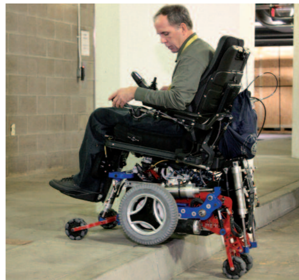
Roboter-Rollstuhl MeBot mit der Fähigkeit zum Treppensteigen.
